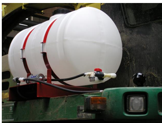
APPLI-PRO® Basic na samojízdné řezačce a na drtiči kukuřičného zrna.
