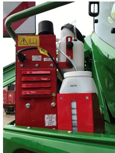
APPLI-PRO® C500 na samojízdné řezačce JD 9600i. Aplikátor pracuje v automatickém režimu. To znamená, že automaticky dávákuje konzervant podle naměřených hodnot z řezačky.
