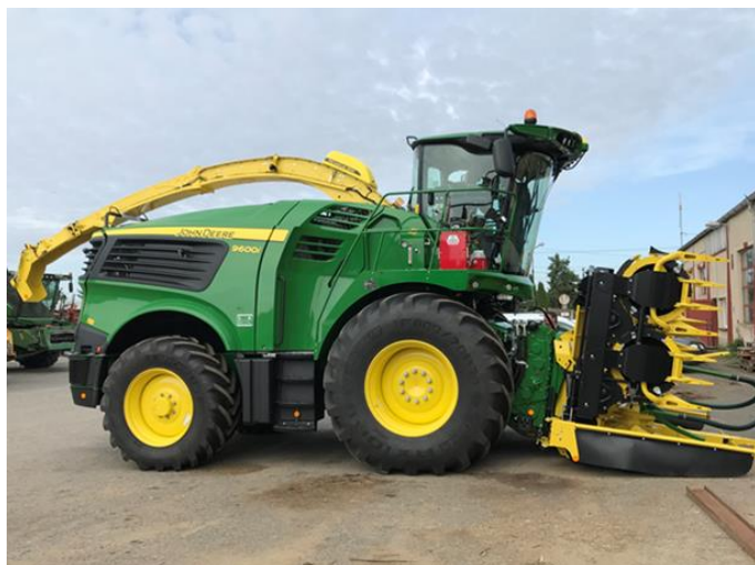
APPLI-PRO® C500 na samojízdné řezačce JD 9600i. Aplikátor pracuje v automatickém režimu. To znamená, že automaticky dávákuje konzervant podle naměřených hodnot z řezačky.
